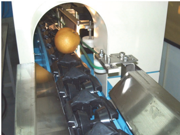
圖 8. 梨進入定距式水果排列裝置之情形
