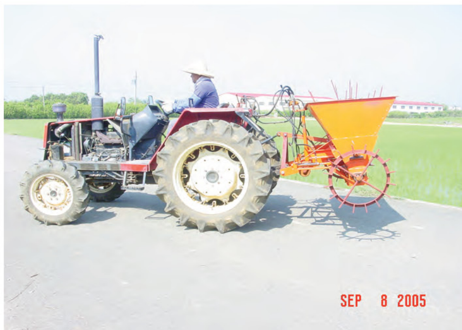
圖 2. 多用途施肥機與曳引機連接側視圖
