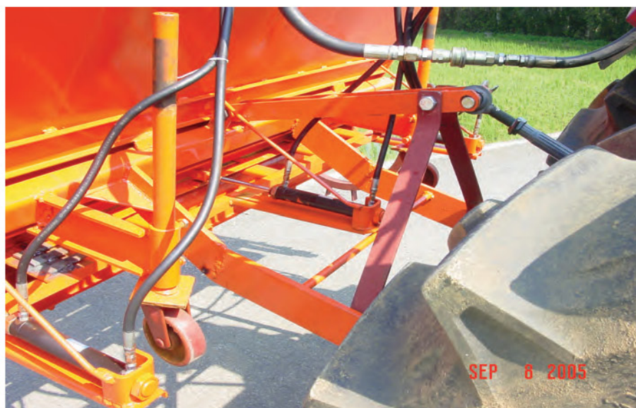
圖 3. 施肥機與曳引機三點連接示意圖
