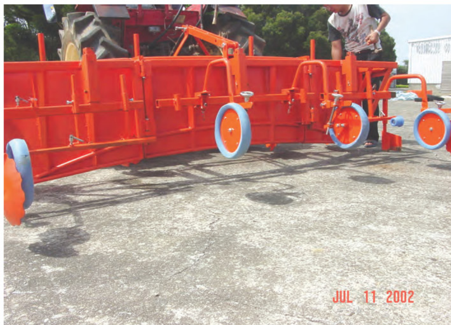
圖 1. 附掛摺疊式塑膠布覆蓋機後視圖
