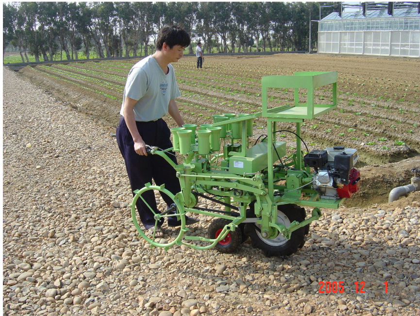
圖 3. 研製完成三輪驅動兩行式蔬菜移植機
