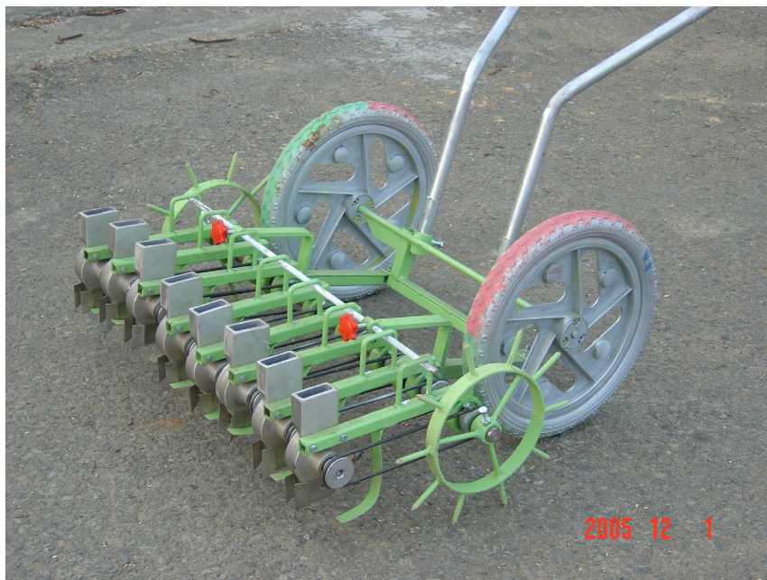
圖 6. 研製完成的蔬菜播種機 Fig. 6. View of vegetable seeder.
