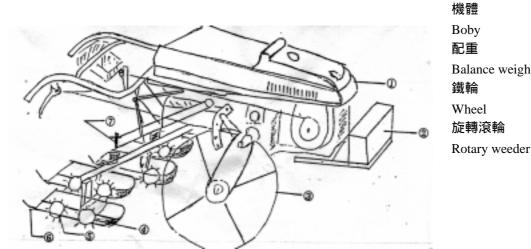
Boby 配重 Balance weight 鐵輪 Wheel 旋轉滾輪
