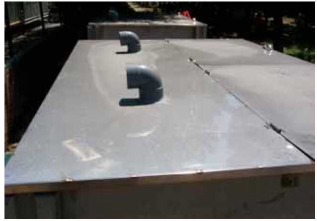
堆肥箱頂部可折疊式鋁合金蓋及出氣孔 L 型塑膠水管
