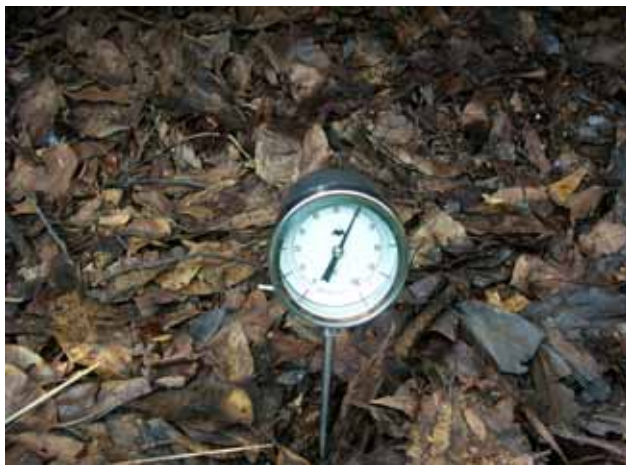
堆肥體以鋁合金溫度計量測溫度，提供打氣通風設定之依據
