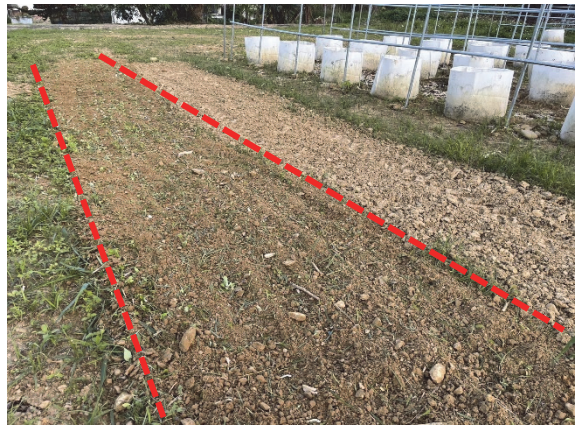
圖 10、低速檔(烏龜)一檔，耕耘刀 1000 rpm 耕土結果
