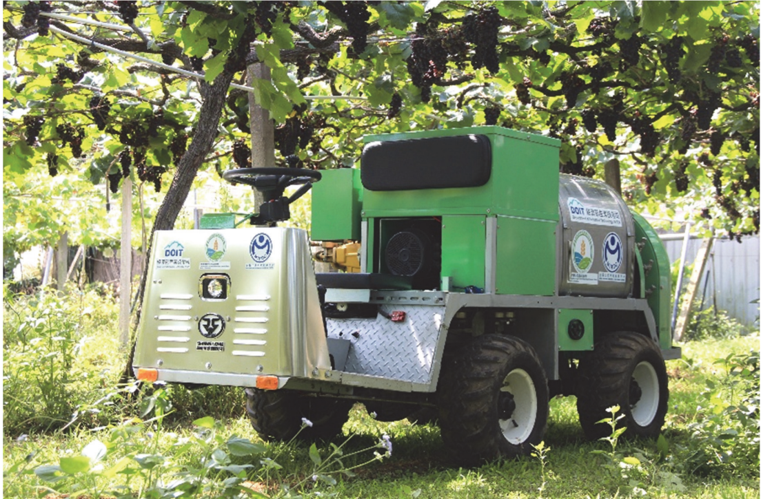
圖 1、電動化施作之鼓風噴霧機
