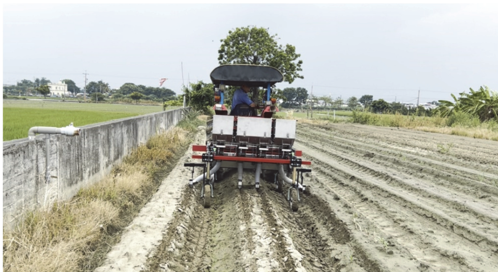
圖 3、施肥機具繫結於曳引機進行田間行走測試
