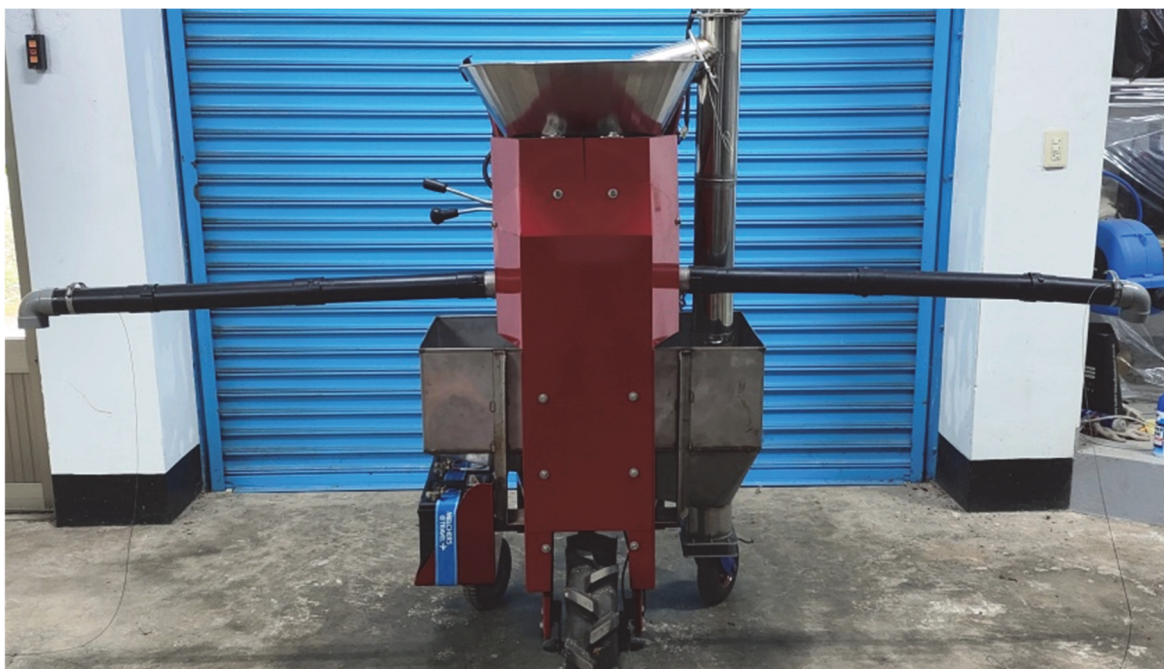
圖 2、茶園多行式電動施肥雜型機
