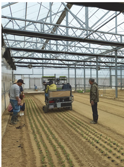
圖 5、土壤整地鎮壓後，以電動履帶式移植機移植菜苗
