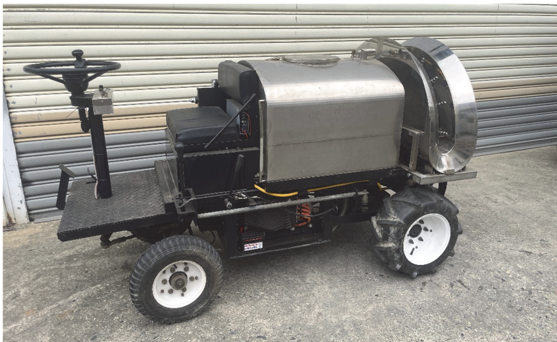
圖 1、研製之乘坐式果園電動噴霧機械
