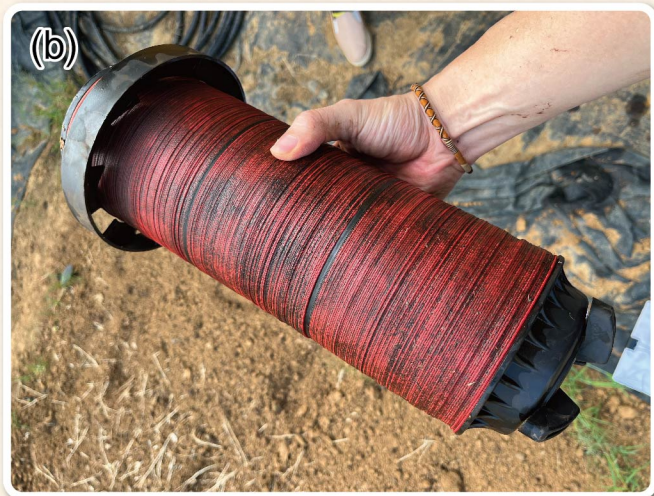
圖1. 檢查過濾器。(a)過濾器前後壓力差值不超過 1\text{kg}/\text{cm}^2 ，(b)濾心阻塞時需清潔濾心。
