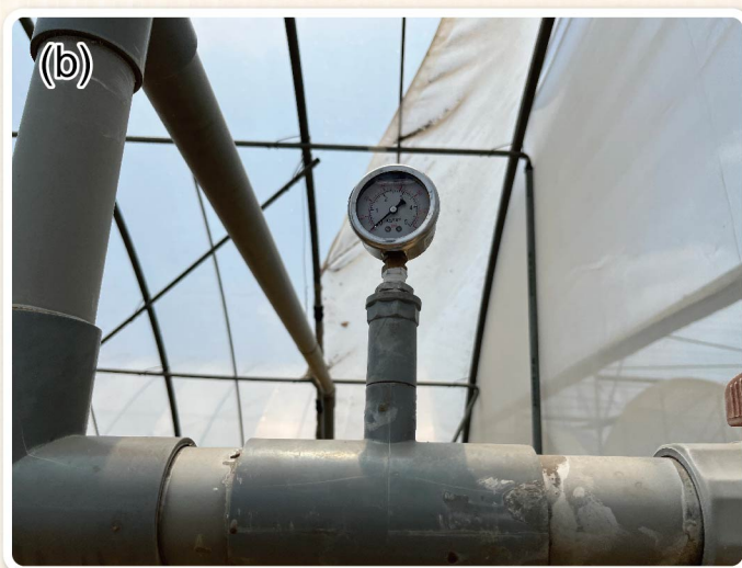
圖5. 檢查噴灌時水壓是否正常，於(a)幫浦後方和(b)溫室噴灌支管的噴頭處(直接與銅質固定式噴頭更換)安裝壓力計，在噴水時記錄讀值。
