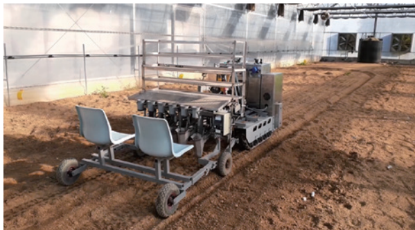
▲ 圖 2. 本場研發新概念電動曳引設備附掛移植機具。
