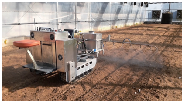
▲ 圖 1. 本場研發新概念電動曳引設備附掛噴藥機具。
