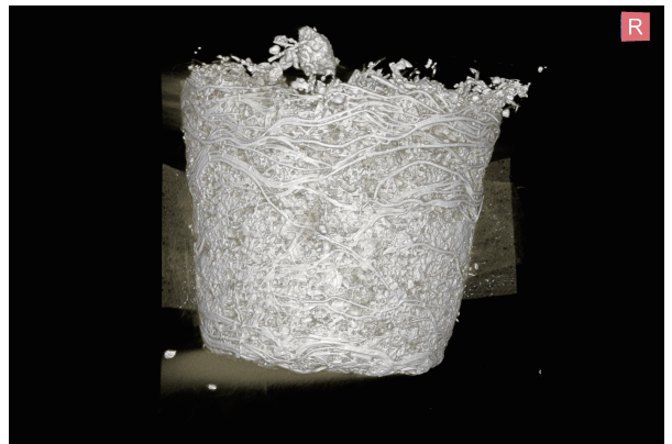
▲ 圖 3. micro-CT 技術觀測青梗白菜穴盤苗因介質含水量過高導致分辨率低。
