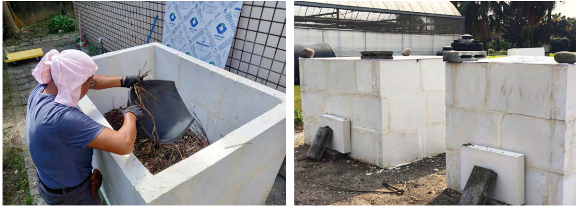
圖 9. 運用智慧通氣保溫式堆肥裝置（新型專利字號 M660091）與桃園場配套開發之改良式堆肥技術，解決校園樹枝落葉廢棄物資源循環再利用。
