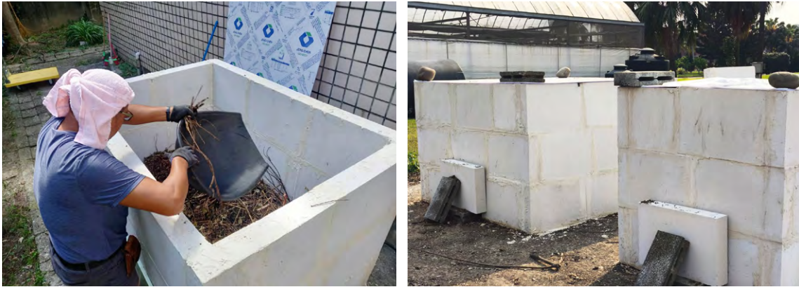
圖 9. 運用智慧通氣保溫式堆肥裝置（新型專利字號 M660091）與桃園場配套開發之改良式堆肥技術，解決校園樹枝落葉廢棄物資源循環再利用。
