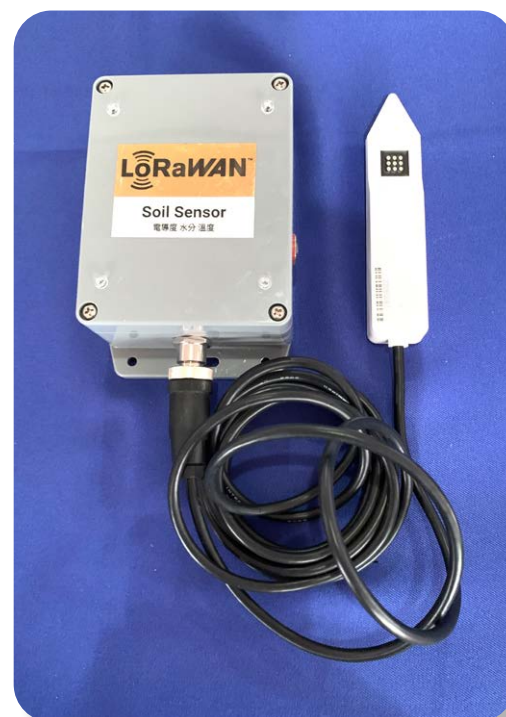
灌溉控制系統使用之土壤感測器
