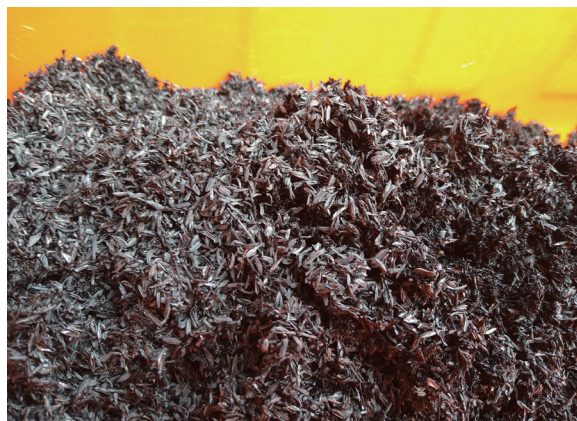
▲圖 6. 利用改良式簡易炭化爐燒製之炭化稻殼成品。
