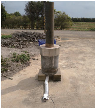
▲圖 2. 改良式簡易炭化爐。 ▲圖 3. 稻殼生物炭燒製技術實作解說。 ▲圖 4. 水稻田施用炭化稻殼。
