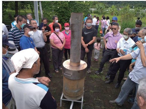
▲圖 2. 改良式簡易炭化爐。 ▲圖 3. 稻殼生物炭燒製技術實作解說。 ▲圖 4. 水稻田施用炭化稻殼。
