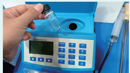
▲圖 2. 水耕養液及土耕栽培介質之 pH 及 EC 檢測技術與設備。
