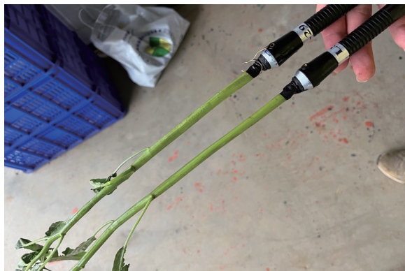
▲圖4. 測量去根薤菜溫度需將熱電偶確實刺入莖空腔內。
