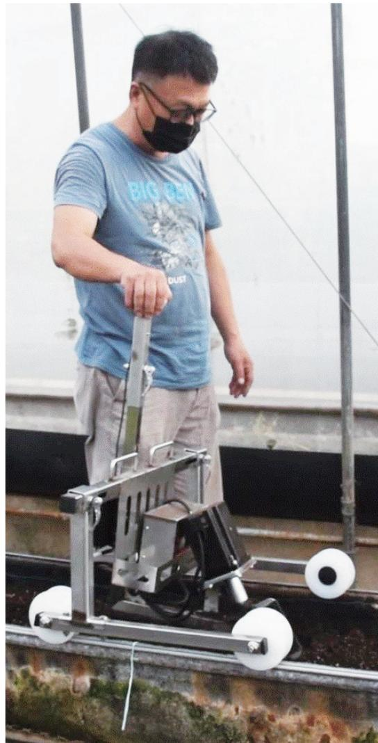
▲圖 3. 槽耕電動鬆土機作業模式。
