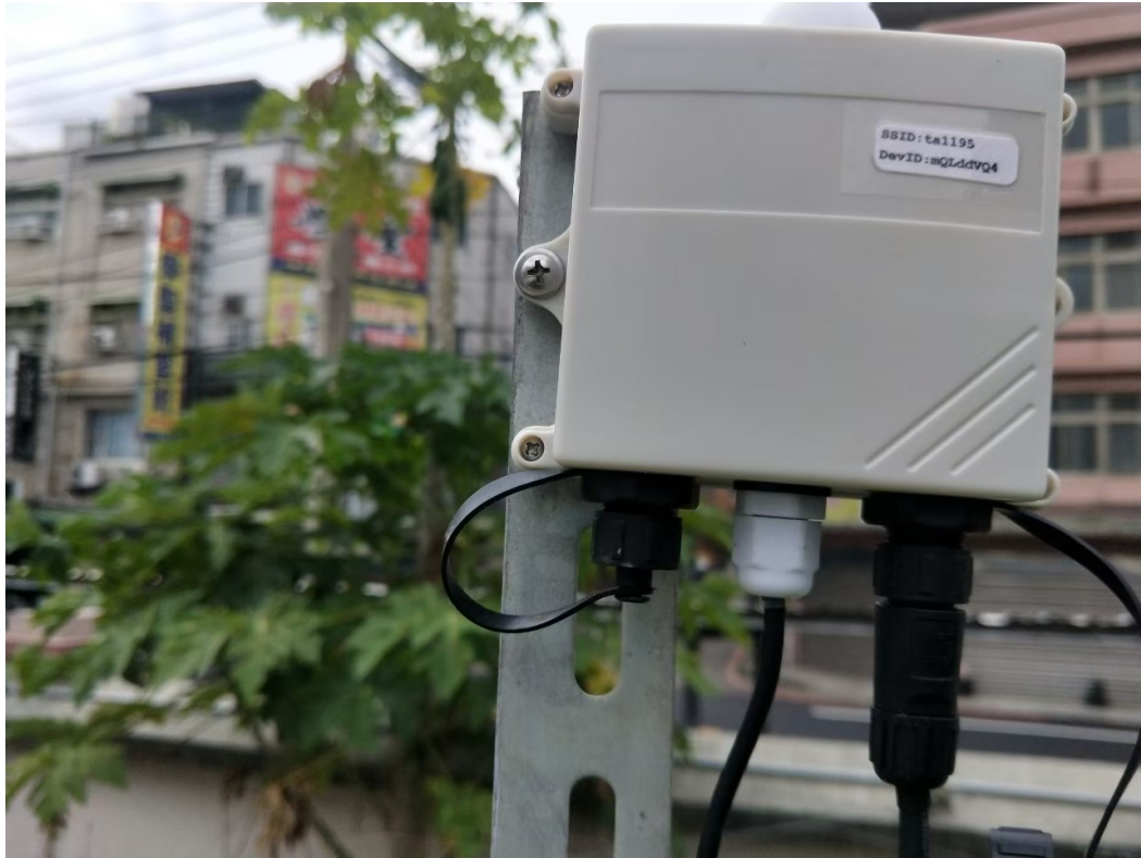
圖 5. 澆水管理模組中的環境感測器具備有偵測光度、土壤濕度及空氣溫濕度的功能。
