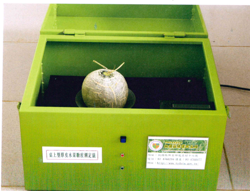
圖 2. 桃改 I 型水果糖度測定儀操作情形
