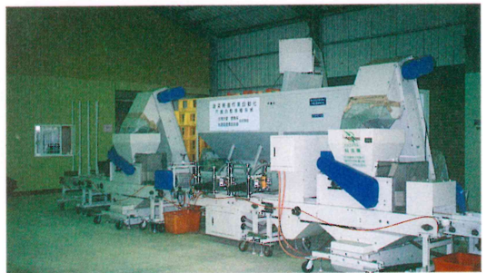
▲蔬菜穴盤自動化育苗播種系統機組
