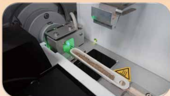
土壤樣品盛裝於陶瓷進樣槽直接進樣分析
