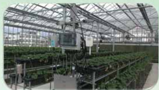
農業用無線通訊感測系統於立體化草莓栽培的應用
