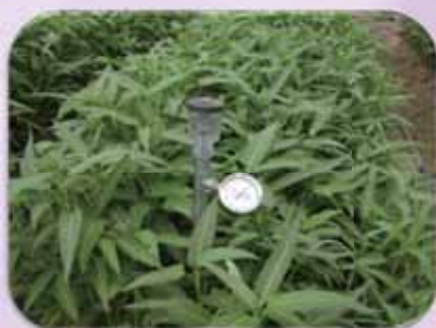
以土壤水分張力計監測土壤含水率
