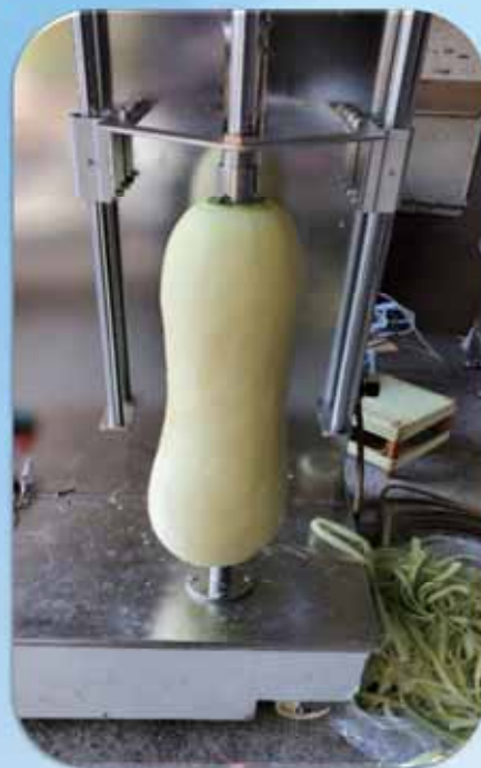
使用本機進行冬瓜削皮後之冬瓜與削下之表皮
