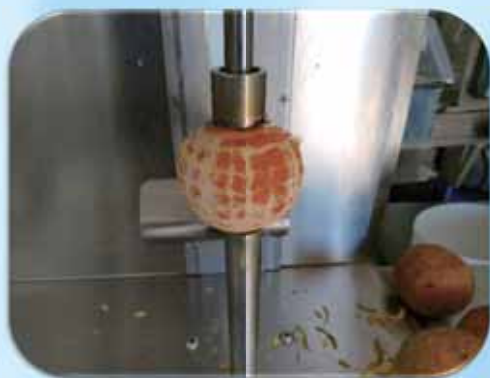
熟果桶柑使用本技術 削皮完成之情形
