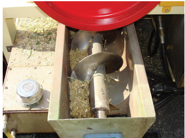
圖3. 植物殘枝粉碎機粉碎後之碎屑經由螺旋輸送裝置排出
