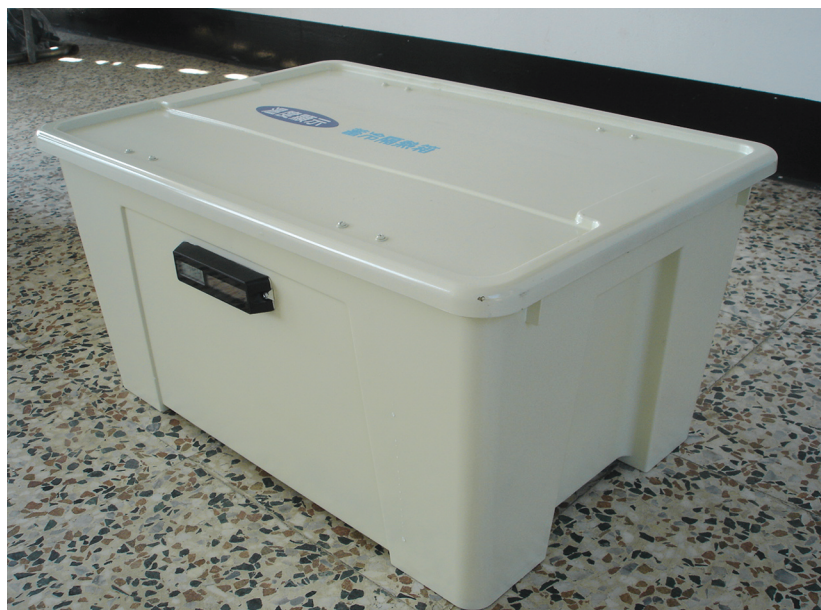
圖1. 具導流及溫度監測功能之保溫裝置外觀
