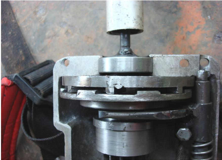
圖 1. 動力接合卸除之剎車結構
