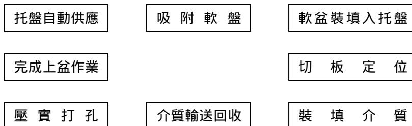
圖 1. 花卉軟盆自動上盆機作業流程
