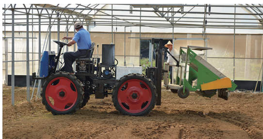
設施用電力行走主機附掛小葉菜移植機
