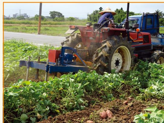
曳引機附掛甘藷去藤收穫一貫作業機施作情形
