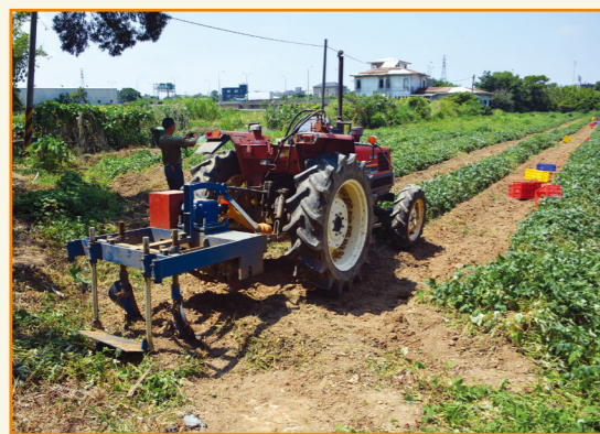
曳引機附掛甘藷去藤收穫一貫作業機
