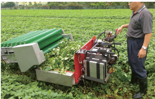
▲圖1. 本場研發之電動葉菜散裝收穫機。
