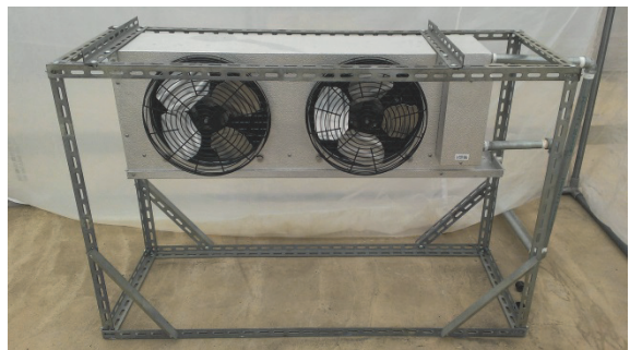
圖 6. 溫室內部之熱交換機組風扇
