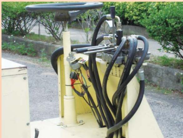
圖三植物殘體粉碎機油壓控制元件
