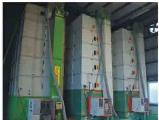
稻穀以循環式乾燥機採三段式變溫烘乾較佳
