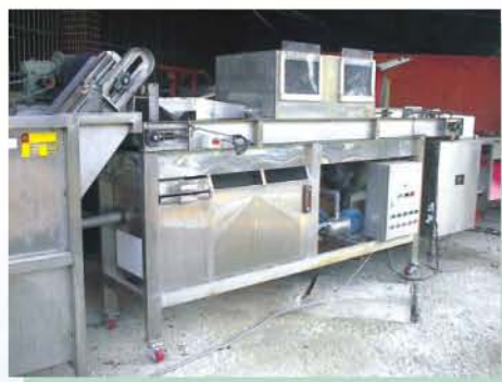
●綠竹筍清洗分級機清洗機構
