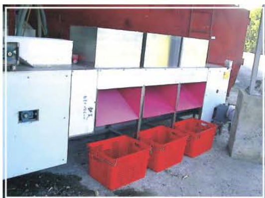
●綠竹筍清洗分級機重量分級機構
