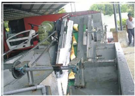
●綠竹筍清洗分級機自動供筍機構綠竹筍供筍輸送情形
