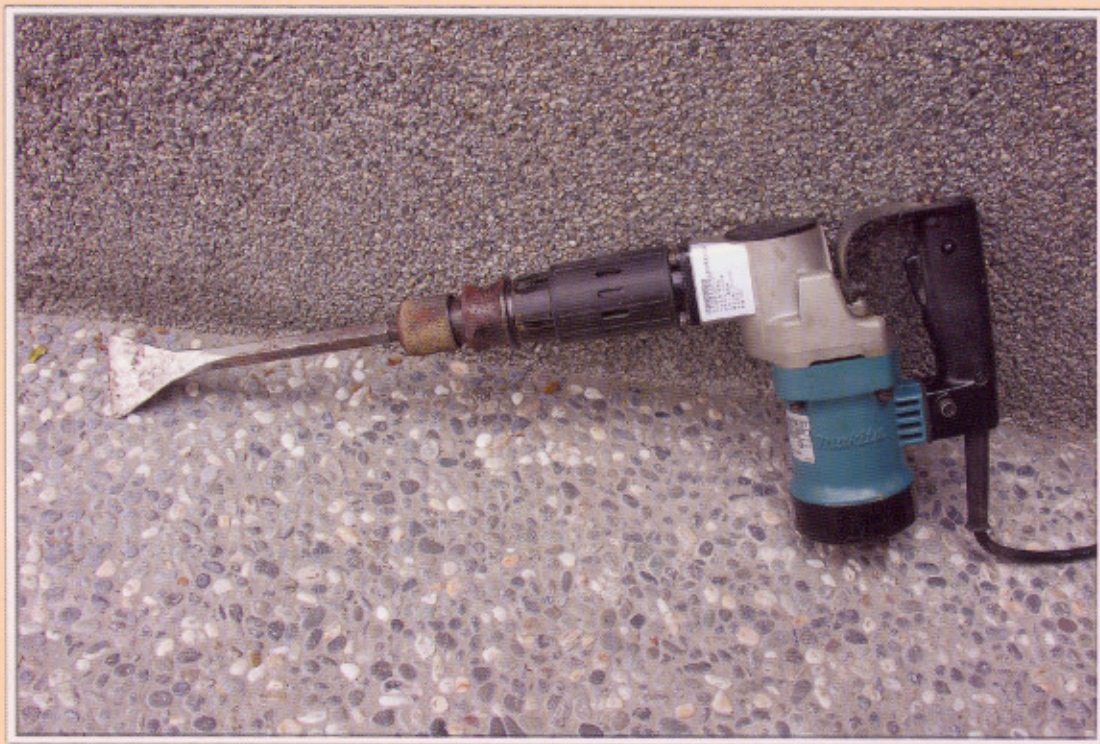
「清竹頭用之動力鑿刀結構」組裝後整機照片
