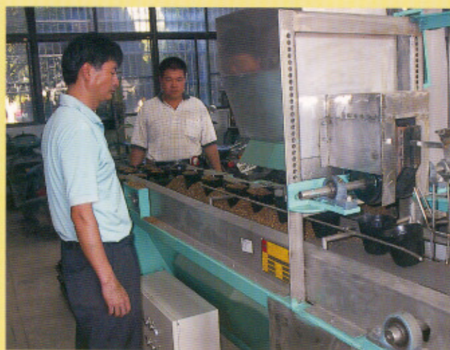
圖 6. 軟盆裝盆機自動撥盆裝盆作業
