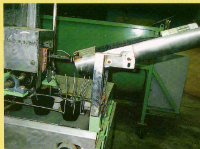
圖4. 軟盆裝盆機自動撥盆機構
