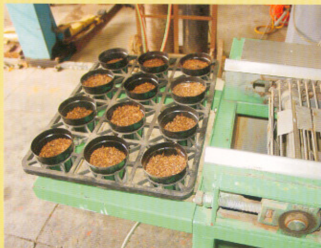
圖 8. 軟盆裝盆機裝盆後情形
