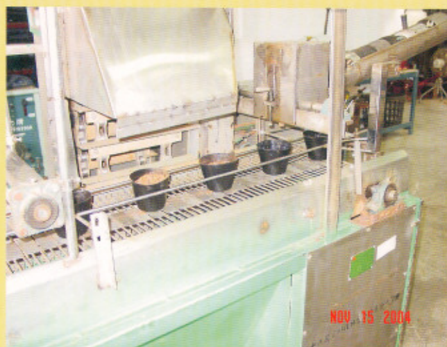
圖 7. 軟盆裝盆機自動裝盆情形
