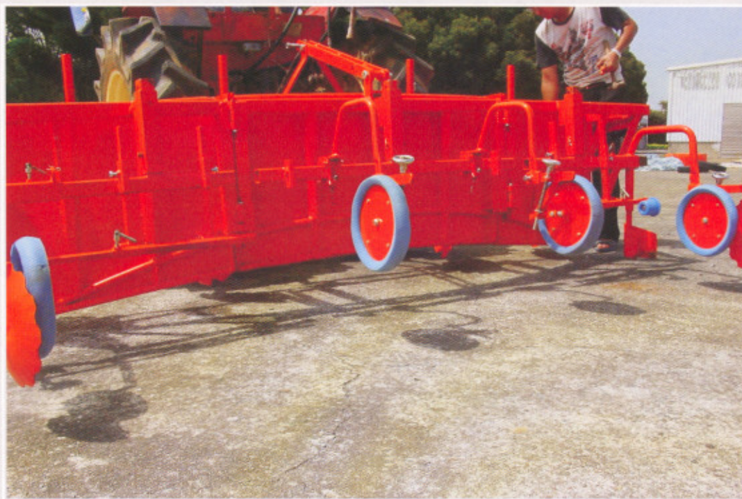
圖1. 附掛折疊式塑膠布覆蓋機之後視圖
