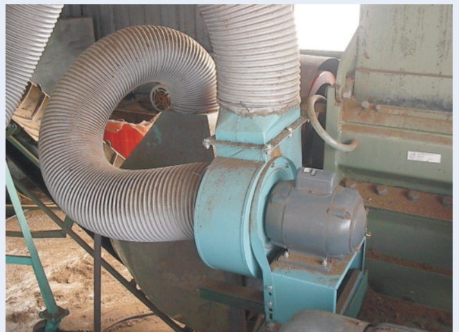
圖 4. 粉碎機吸塵機構
