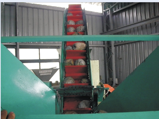
圖 6. 椰殼粉碎機椰殼輸送作業情形
