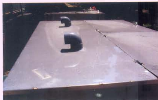
堆肥箱頂部可折疊式鋁合金蓋及出氣孔 L 型塑膠水管
