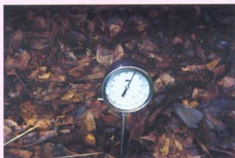
堆肥體以鋁合金溫度計量測溫度，提供打氣通風設定之依據
