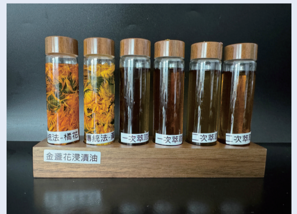
▲圖 3. 新開發超音波水浴萃取技術之萃取效率（左 3 至 6）高於傳統製程（左 1 至 2）。
