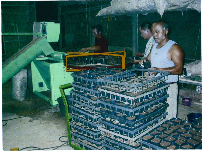
圖 3. 介質裝填作業情形
