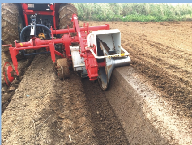
▲ 圖3.築田埂機作業情形(單側)
