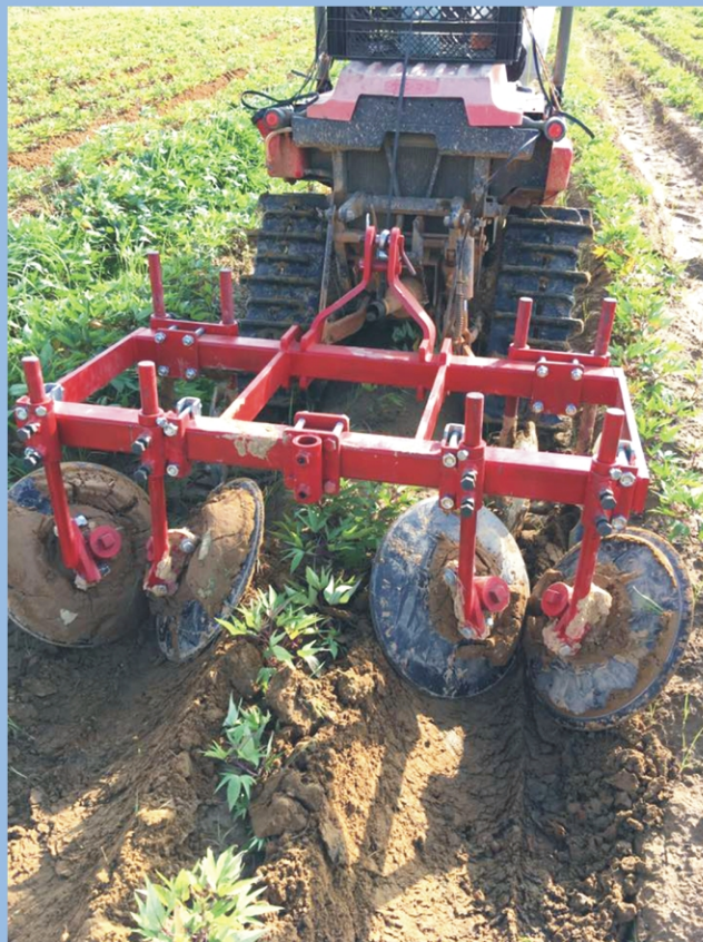
▲ 圖14. 圓碟培土器使用情形
