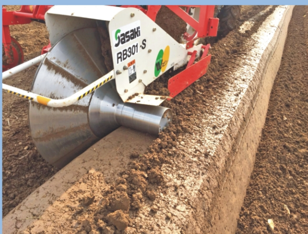
▲ 圖4.築田埂機作業情形(兩側)
