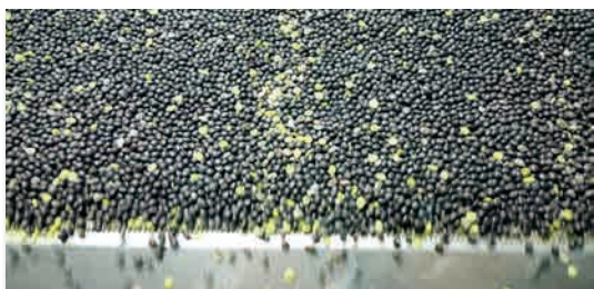
▲磨光機作業後的大豆(黑豆)樣態。透過磨擦原理去除大豆表面粉塵，增加種皮亮度，並以篩網將破損粒剔除，提高產品附加價值。
