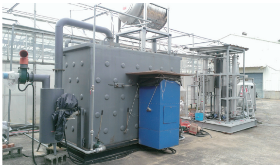
▲圖 6. 本場開發之生物質熱能製冷系統。
