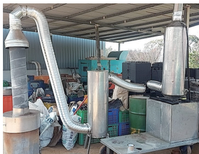
▲ 圖 4. 簡易型炭化爐及集煙系統。
