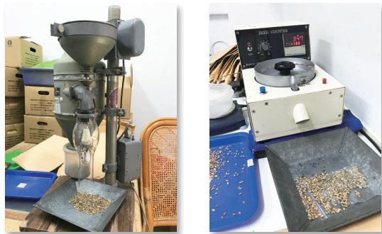
▲ 圖8. 生育後期耐寒檢定-透過風選機與數粒機判別稔實與不稔實粒數。
