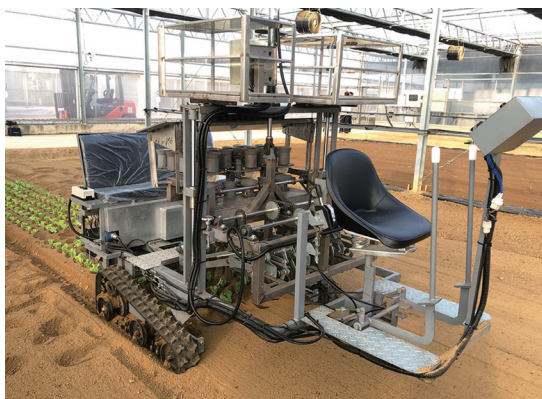
履帶式電動設施葉菜移植機溫室莖菜苗移植情形
